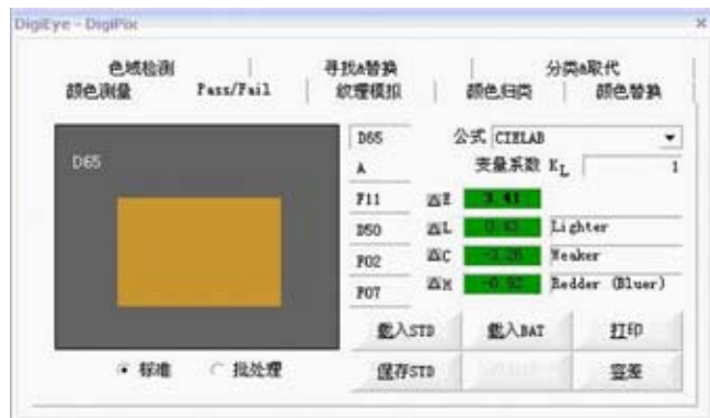
图10 色差判断Pass/Fail
